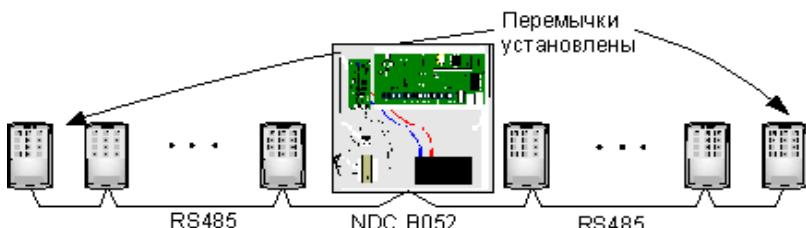
Установка перемычек в шлейфе контроллеров (подключается ко второму последовательному порту)
