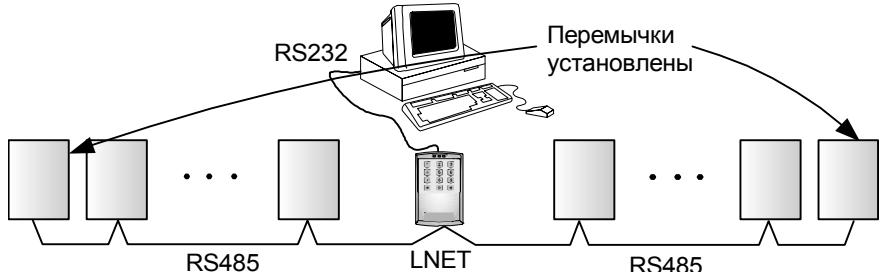
Установка перемычек в шлейфе модулей расширения (подключается к первому последовательному порту)
