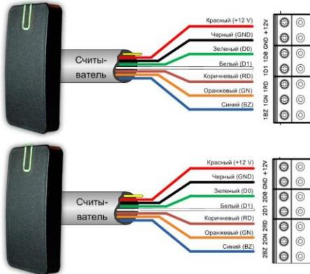
Рис.11. Подключение считывателей
