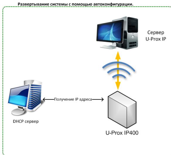
Рис.5. Автоконфигурация устройства
