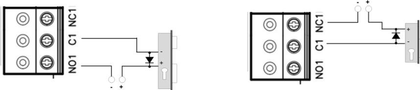
Рис.16. Подключение замков при использовании внешнего источника питания
