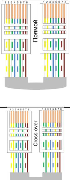
Рис.9. Подключение кабеля Ethernet
