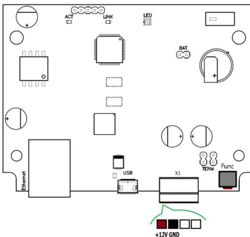
Рис. 2б. Внешний вид платы контроллера модификации 2
