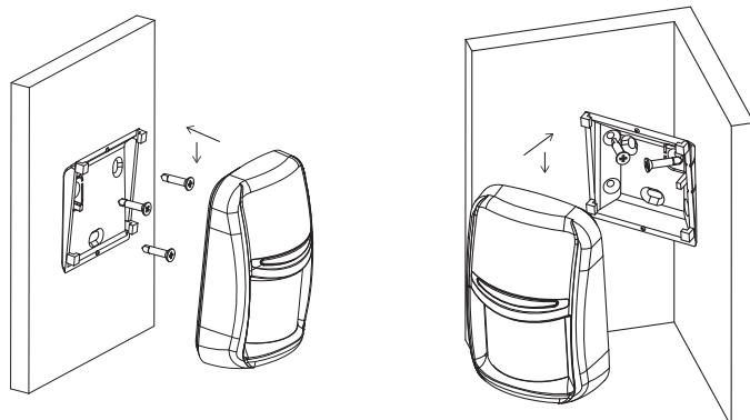
2. Установите устройство на кронштейн **5** и сдвиньте его вниз для фиксации и блокировки тампер-контакта **6**. Вспышки на световом индикаторе **3** подтверждают, что тампер зафиксирован.
