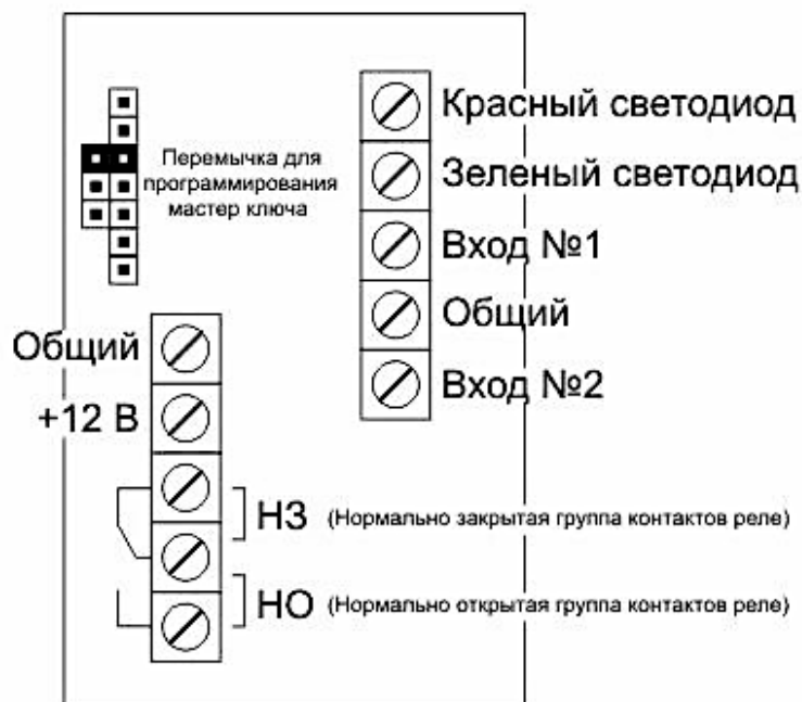
Рисунок 1 – Обозначение разъемов локального модуля контроля доступа iBC - 04
