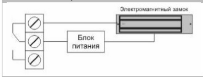
Рис. 2. Схема подключения электромагнитного замка
