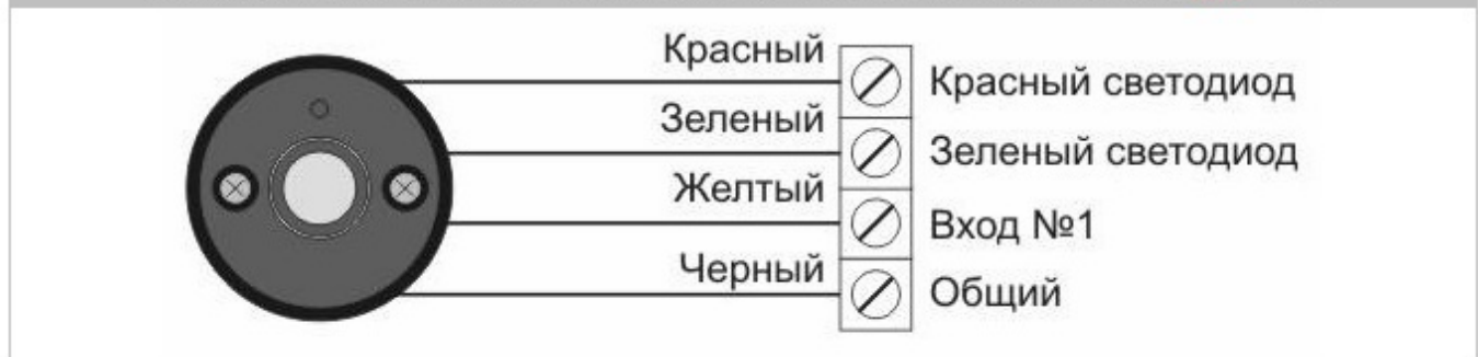
Рис. 4. Схема подключения считывателя ключей iButton (TouchMemory) iBR-XX
