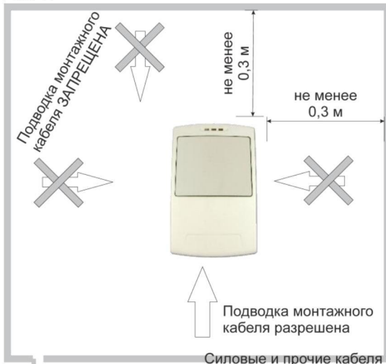
Рис.4. Установка базового блока.
