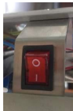
б) кнопка вкл/выкл питания 220 V
