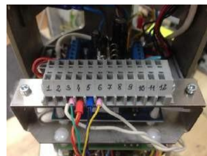
Рисунок 11 – Подключение кабеля связи с пультом управления к клеммам
