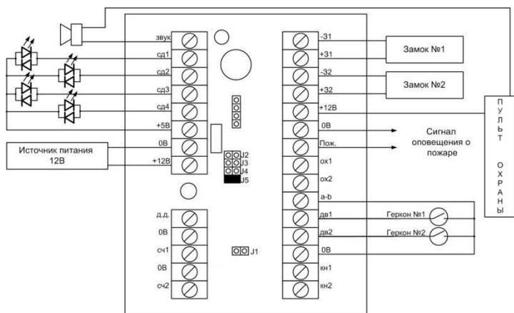
Рис.7. Схема подключения контроллера для режима прохода № 6
