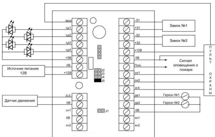
Рис.6. Схема подключения контроллера для режима прохода № 5, 6
