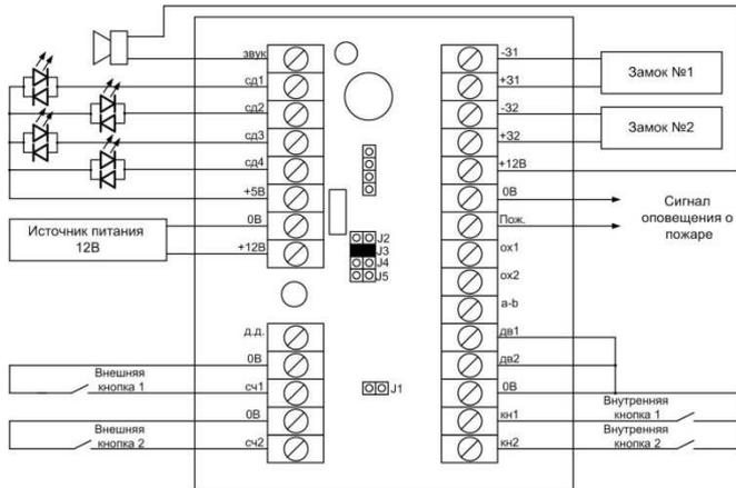
Рис.4. Схема подключения контроллера для режима прохода № 2
