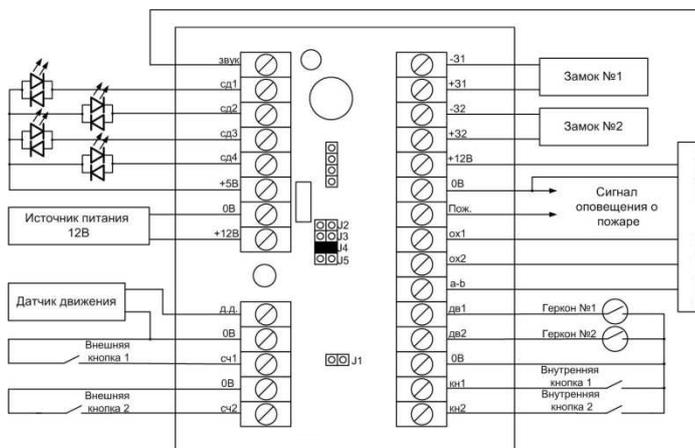
Рис.5. Схема подключения контроллера для режима прохода № 3
