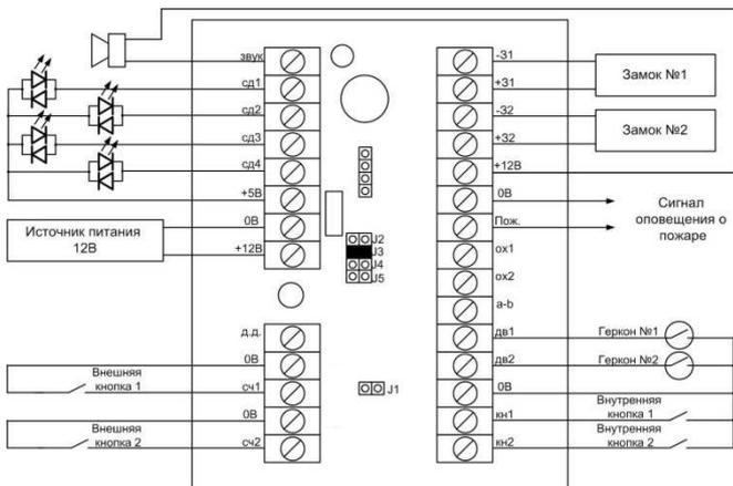
Рис.3. Схема подключения контроллера для режима прохода № 1
