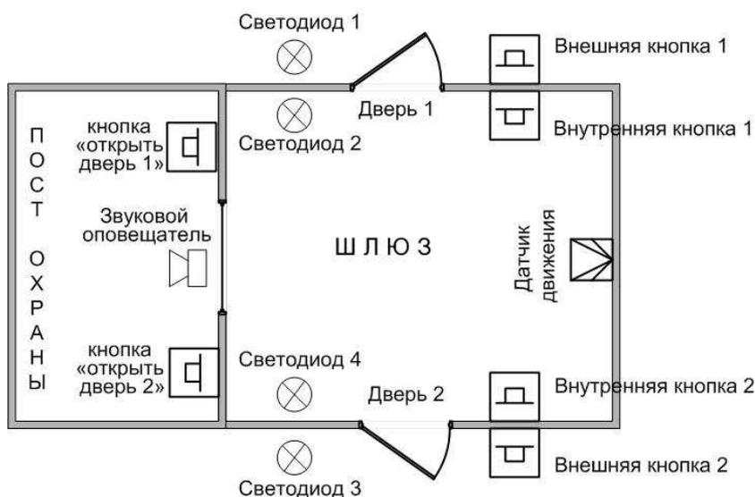
Рис 1. Схема шлюза
