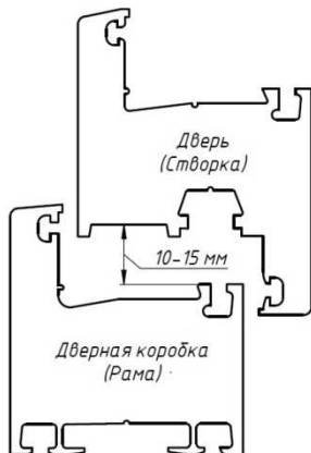
Рис.9. Допустимый зазор между дверной коробкой и дверью
