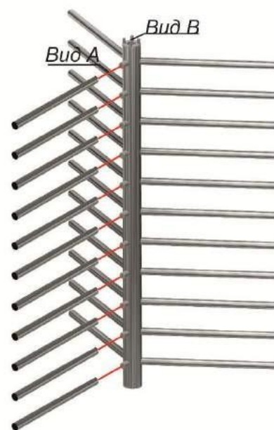
Рис.8– Установка ротора турникета и поводков
