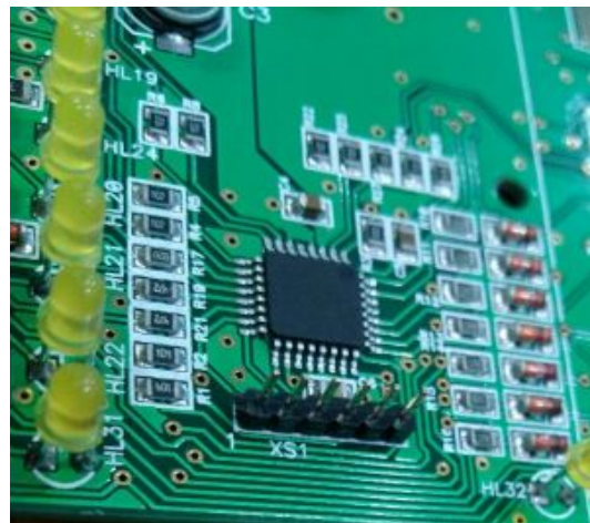
Рисунок 3. Разъем для обновления ПО
