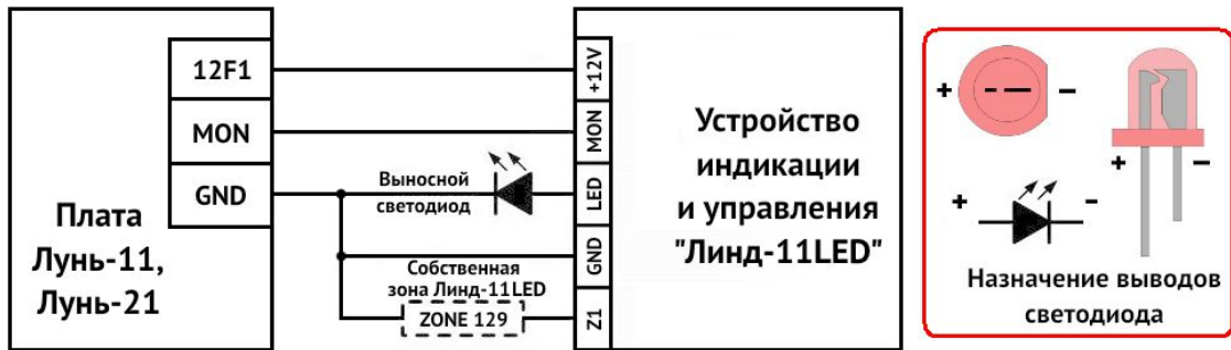
Рисунок 7. Схема подключения УИУ к ППКОП серии «Лунь-11», «Лунь-21»
