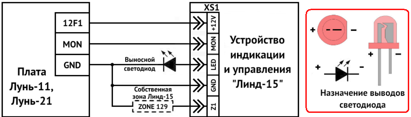
Рисунок 22. Схема подключения УИУ к ППКОП «Лунь-11», «Лунь-21»
