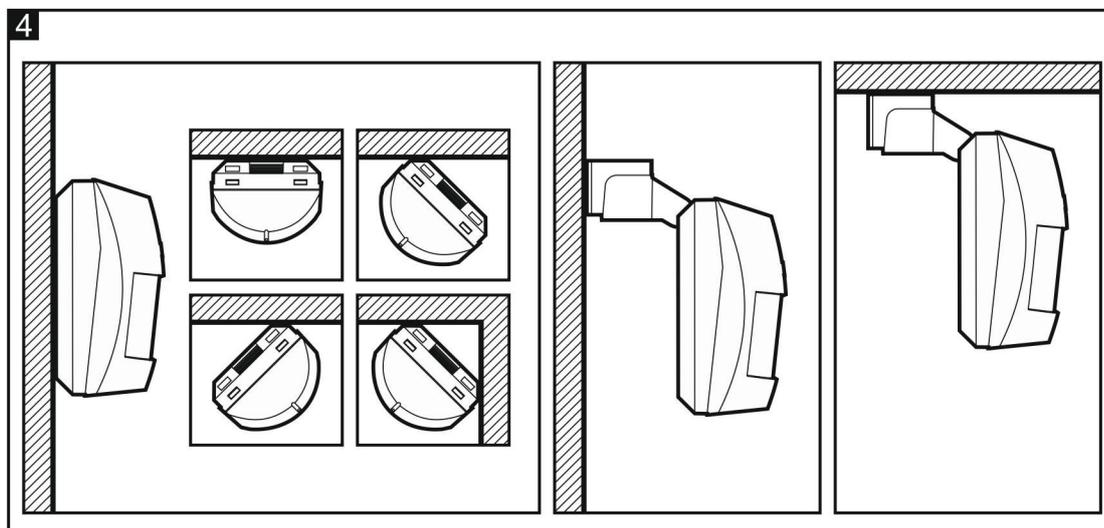
5. Прикрепите основание корпуса непосредственно к стене или к кронштейну, установленному на стене или потолке (рис. 4 и 5). Извещатель нельзя устанавливать на кронштейне, если должна быть включена опция игнорирования животных.
