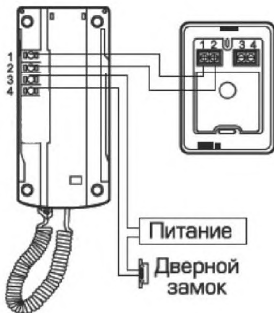
Схема подключения DP-2S
