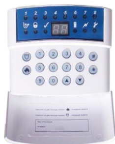
Рис. 2. Беспроводная клавиатура М4064КР
