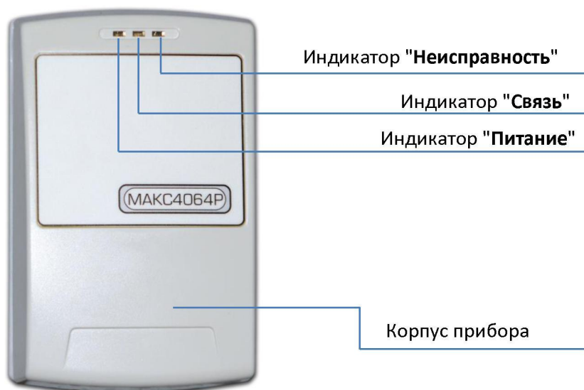
Рис. 14. Прибор МАКС4064Р II в корпусе
