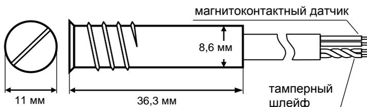
Рис. 3. Геркон извещателя S-3 в металлическом корпусе
