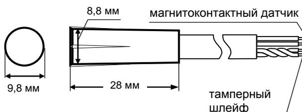
Рис. 2. Геркон извещателя S-2 в пластмассовом корпусе
