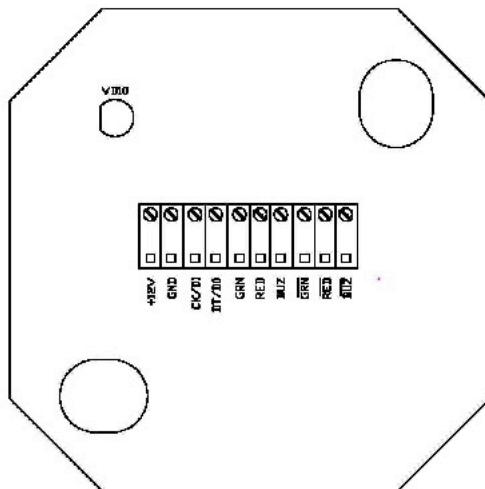
Рисунок А.1 - Елементи СМКС-04, які використовуються при підключені експлуатації.
