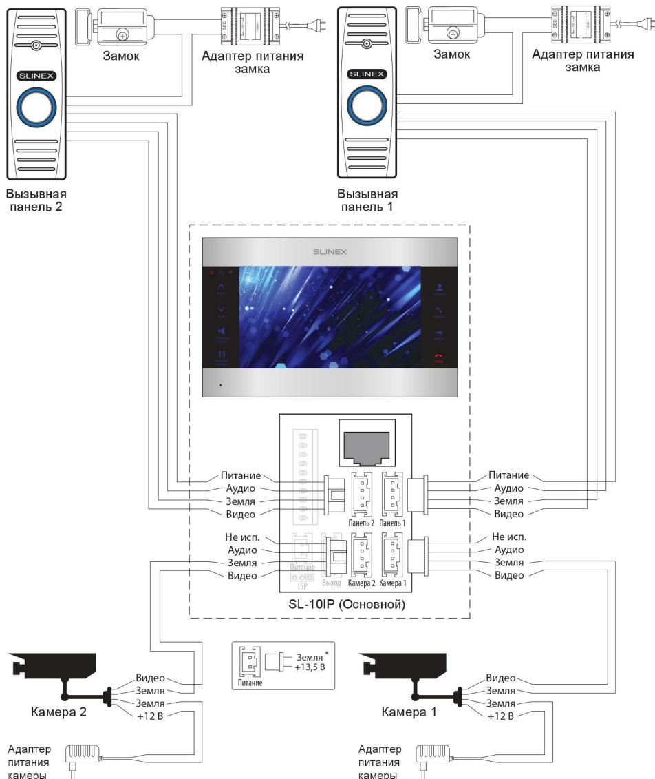
Схема 2. Подключение системы домофонов SL-10IP и SL-07M.
