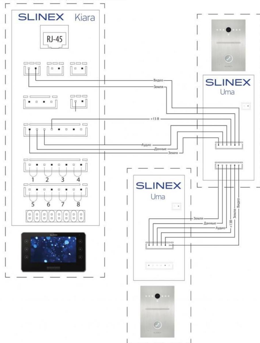
Схема 3. Пример подключения видеодомофона к локальной сети.
