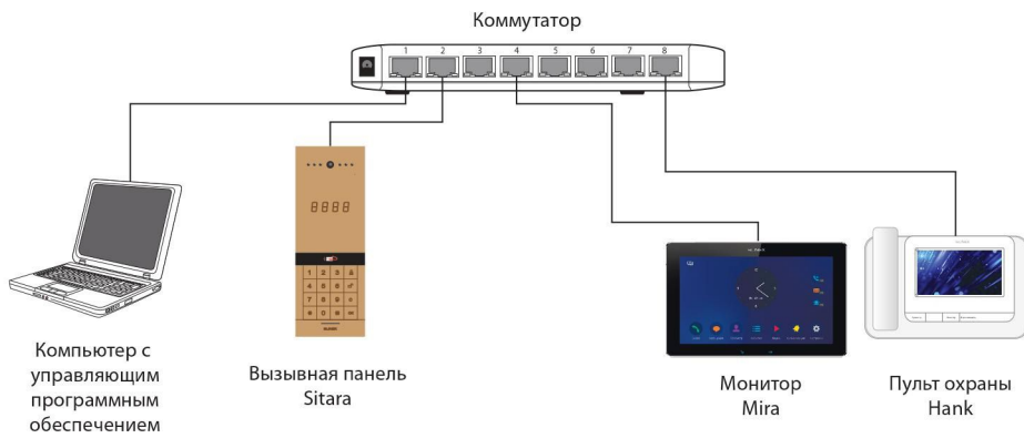
Схема 2. Пример подключения пульта охраны к локальной сети.
