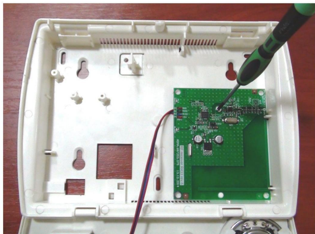
Рисунок 7. Установка радиоприемников серии «P433» в корпус «Лунь-19»
