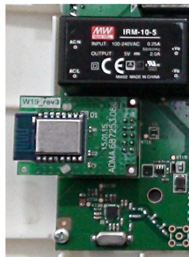
Рисунок 6. Установленный модуль WiFi
