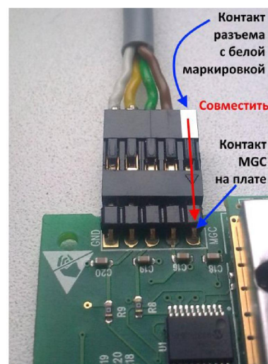
Рисунок 11. Подключение соединительного кабеля радиоприемника Visonic
