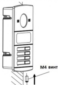
Рисунок 5-4 Установка вызывной панели (DS-KV8X02-IM)
