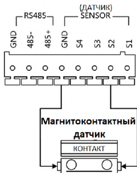
Рисунок 5-18 Подключение магнитоконтактного датчика для моделей DS-KD8102-V/DS-KD8002-VM (2)
