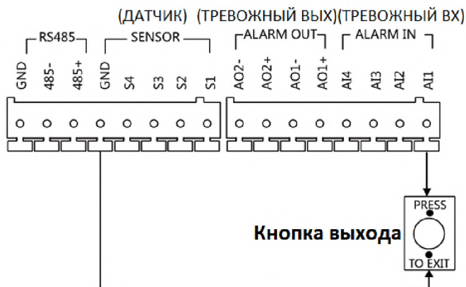
Рисунок 5-20 Подключение кнопки выхода для моделей DS-KD8102-V/DS-KD8002-VM (1)
