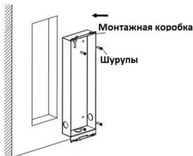
Рисунок 5-3 Установка монтажной коробки в стену
