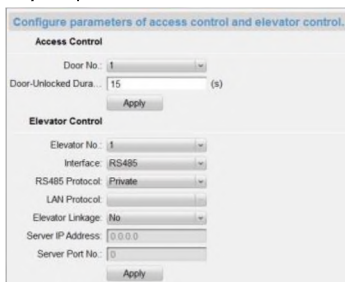
Рисунок 8-33 Меню управления доступом и настройки лифта
