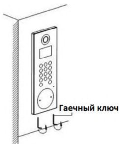
Рисунок 5-5 Затягивание винтов вызывной панели
