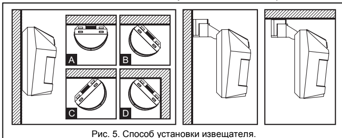
Рис. 5. Способ установки извещателя.
