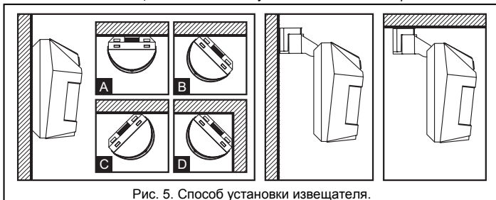
Рис. 5. Способ установки извещателя.
