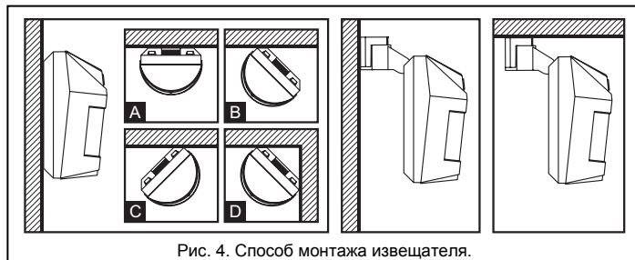
Рис. 4. Способ монтажа извещателя.
