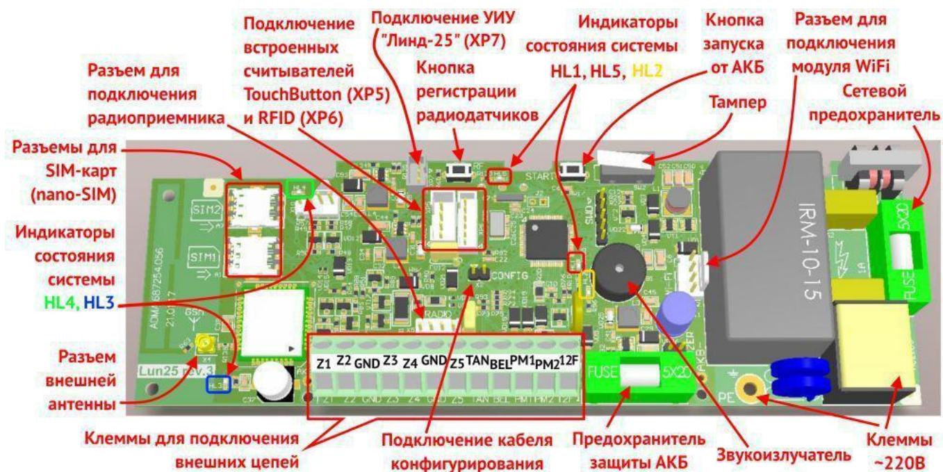
Рисунок 4. Расположение элементов на плате ППКОП
