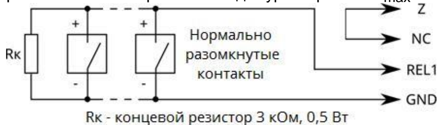
Рисунок 2.4 – Схема включения двухпроводных извещателей с нормально разомкнутыми контактами
