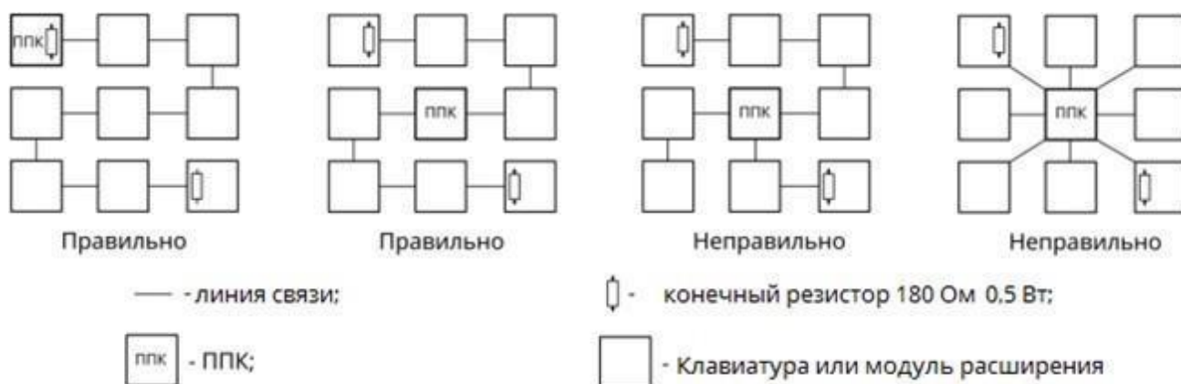
Рисунок 2.1 – Варианты топологии шины RS-485
