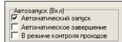
При установленном флаге **Автоматическое завершение** программа будет самостоятельно завершать свою работу, когда все накопившиеся события будут считаны. При установке флага **В режиме контроля проходов** программа продолжит работу в свернутом режиме с выдачей сообщений о перемещении работников в виде всплывающих окон.
