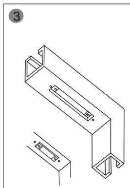
3 установите монтажную планку для полых металлических каркасов
